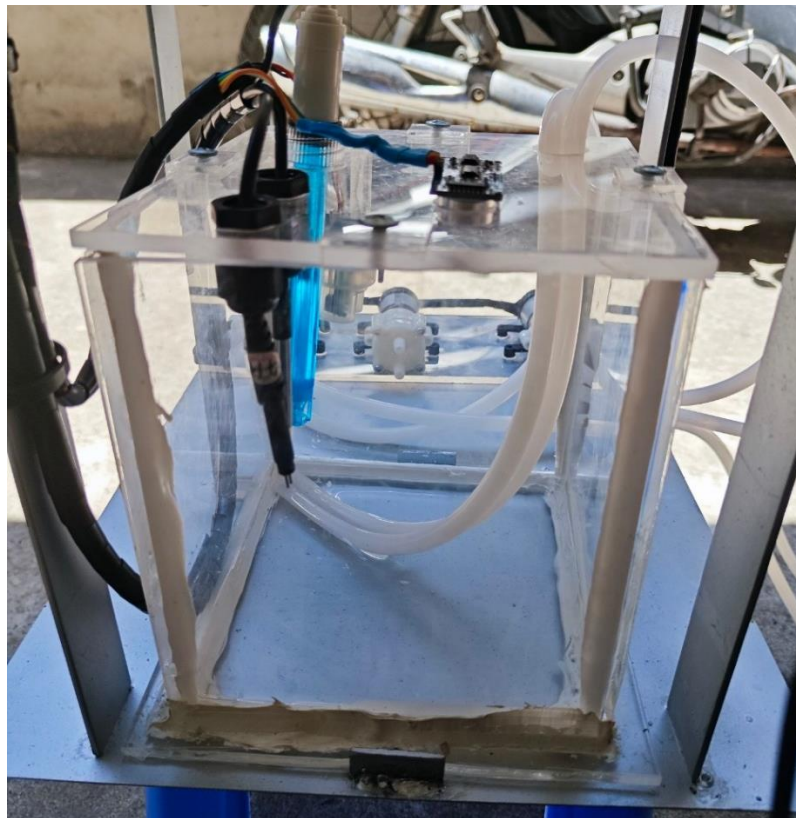
Hình 2-9 Ảnh thực tế kết cấu của bể đựng nước sau khi lắp đặt
