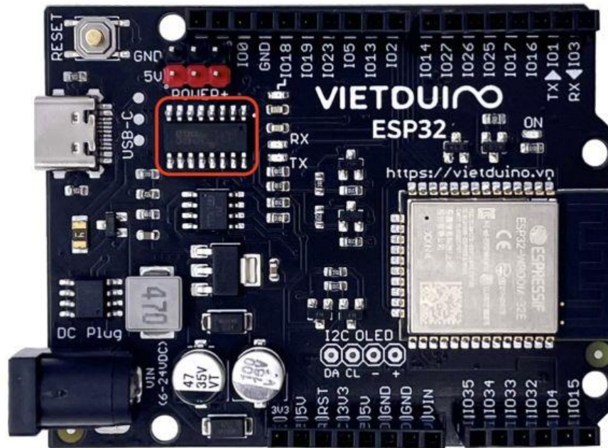
Hình 3-2 Hình IC CH340 trên mạch ESP32
