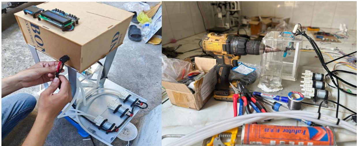
Hình 2-25 Định hình và đi dây trong ruột gà gọn gàng
