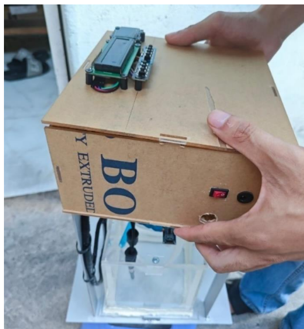
Hình 2-20 Lắp đặt bể nước vào khung
