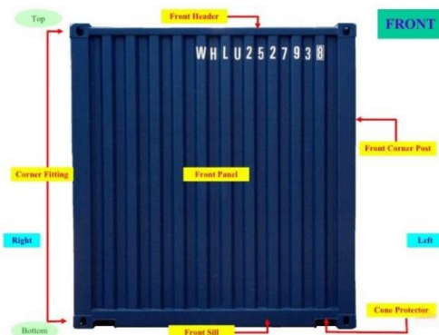
Hình 1. 5. Mặt trước container ( nguồn : https://xuatnhaphkhaughtucte.com/cau-truc-cua-container/ )
