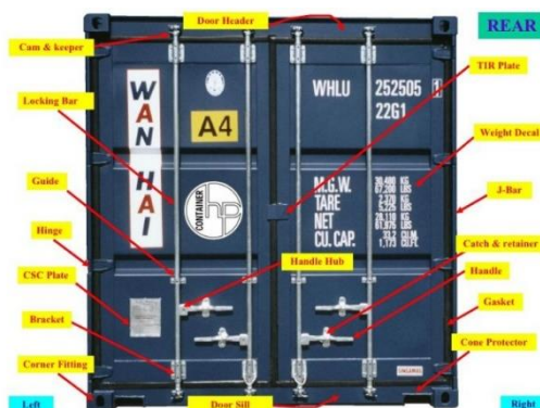
Hình 1. 6. Cửa phụ kiện và mặt sau container ( nguồn : https://xuatnhaphkhaughtucte.com/cau-truc-cua-container/ )
