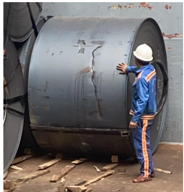
Hình 2.16 Một số cuộn tôn bị hư hỏng trong quá trình xếp dỡ
