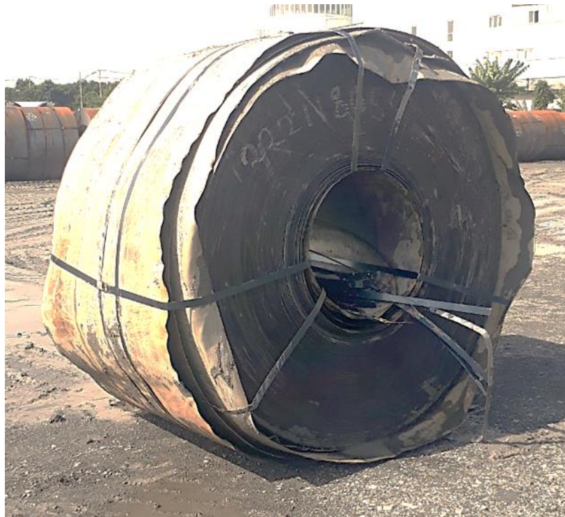
Hình 2.15 Cuộn tôn bị móp mép và bung đai trong lô hàng Thép NK của Cty Kim Quốc
