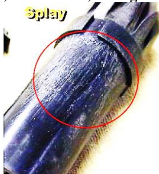
Hình 4.3.9.1. Sản phẩm bị vết xước bề mặt
