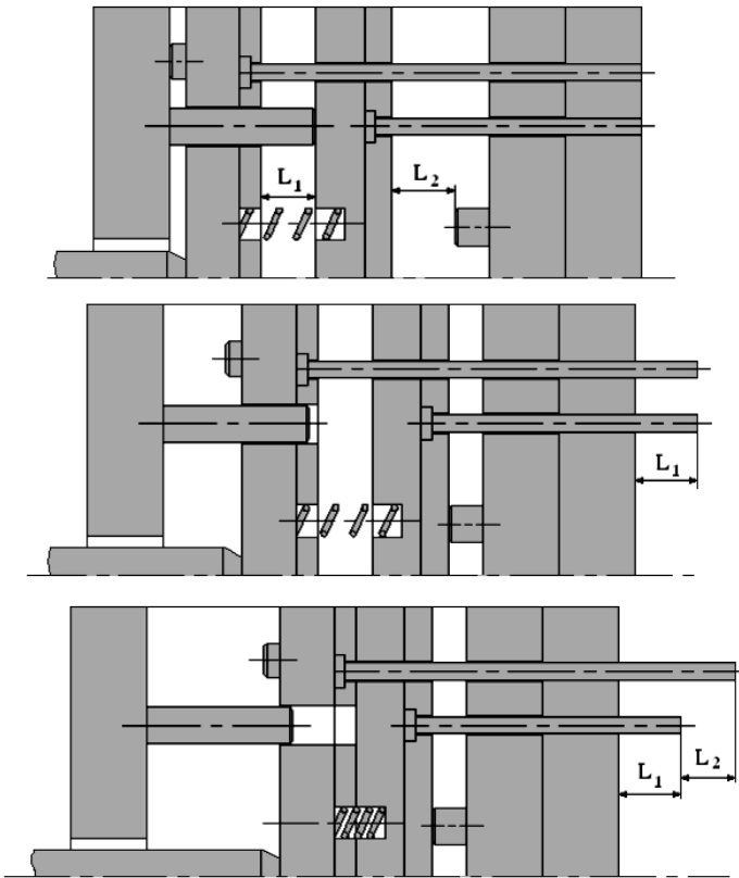
Hình 1.4.5.4. Hệ thống đẩy kép
