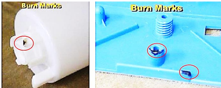
Hình 4.3.11.1. Sản phẩm bị vết cháy
