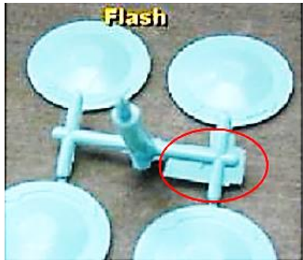
Hình 4.3.6.1. Sản phẩm bị bavìa
