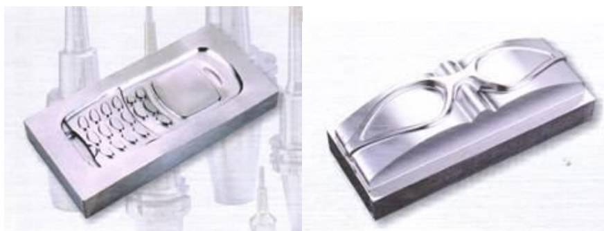
Hình 5.2.4.1. Khuôn làm bằng thép NAK 80
