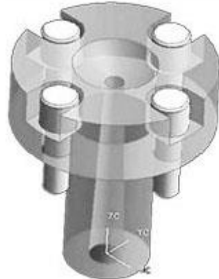
Hình 1.2.2.2. Bạc cuồng phun dùng 4 bulông
