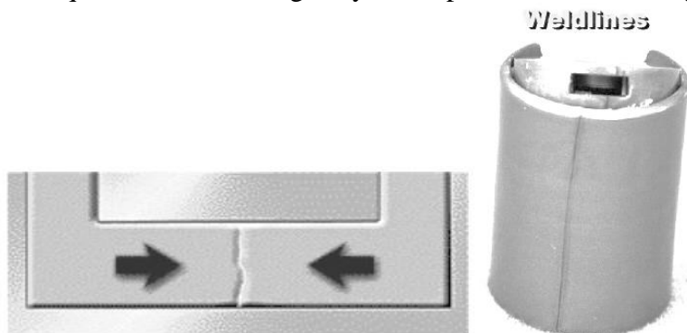
Hình 1.7.1.3. Sản phẩm bị lỗi đường hàn
