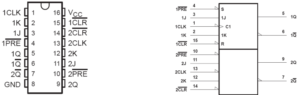
Hình 3-1. Số nào của chân và số nào của ký hiệu của IC Flip Flop 74LS112.
