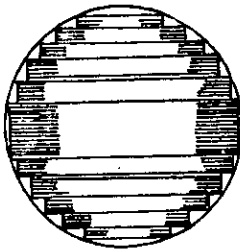
Hình 1-6. Ghép rời lõi thép máy biến áp
