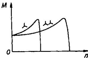
Hình 19-9. Đặc tính cơ M = f(n) của động cơ điện hai tốc độ có sơ đồ đấu dây như ở hình 19-7
