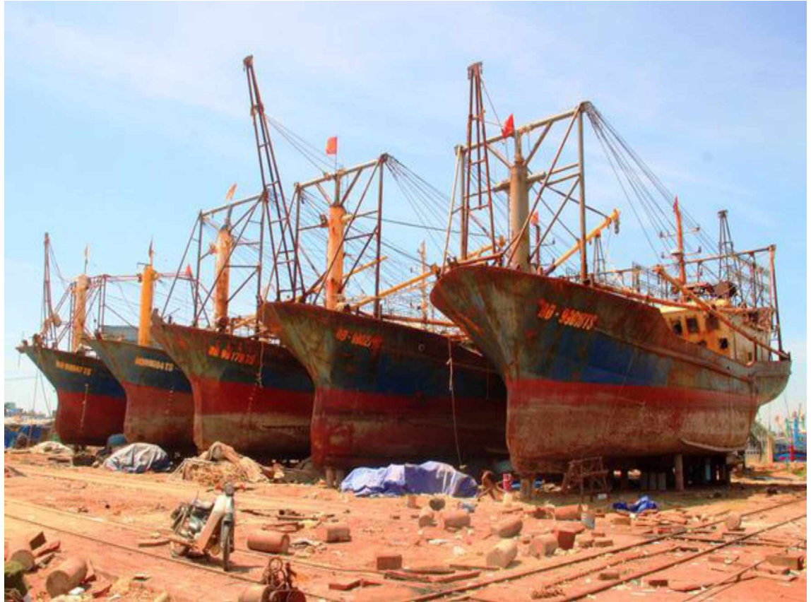
Hình 1: Cận cảnh 5 tàu vỏ thép trị giá mỗi tàu hơn chục tỷ đồng bị rỉ sét do nhiều chỗ dùng thép Trung Quốc kém chất lượng.
